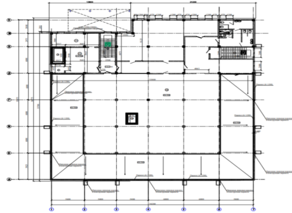
План кровли +9,750 М 1:100
